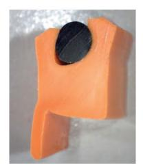
Fig. 10-4. Seal Extrusion
