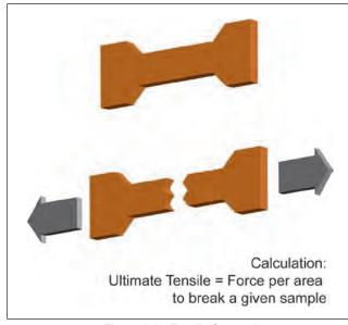
Figure 3-8. Tensile Strength
